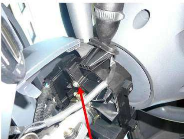
Kytkimen kiinnitys yhdellä "sopivalla" ruuvilla auton valokytkimeen
