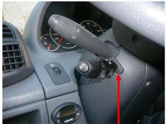
Kytkimen sijainti ja sille tehtävä kolo
